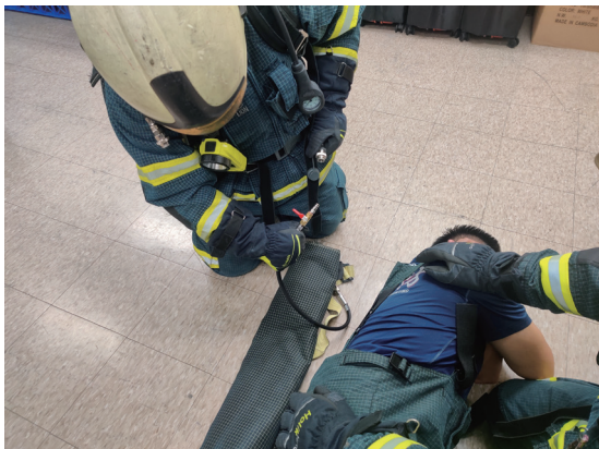
圖 3、充氣管線置於最外層，並有充氣開關閥，消防員可利用背架共生管線充氣。
